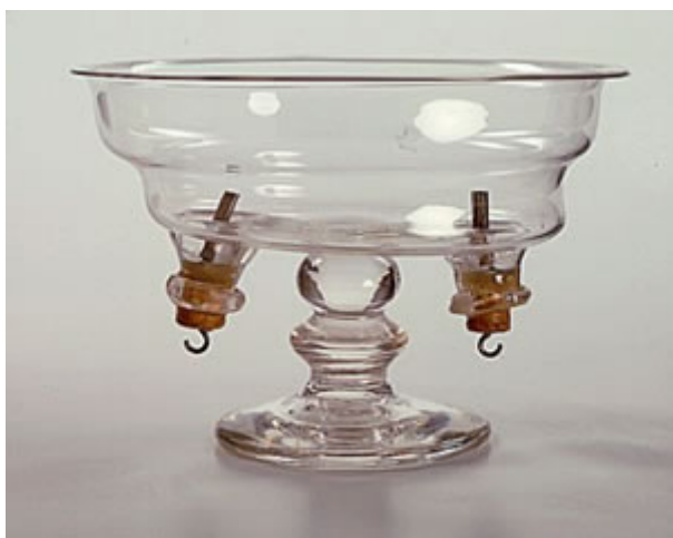
Cuba usada por Davy em seus experimentos com corrente elétrica. Fonte: http://www.dkimages.com ...
